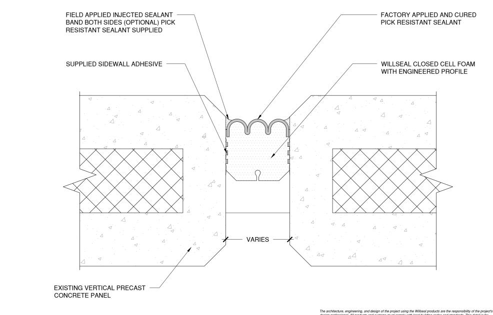
NOTE: RECESS JOINT 1/4" FROM JOINT SURFACE
