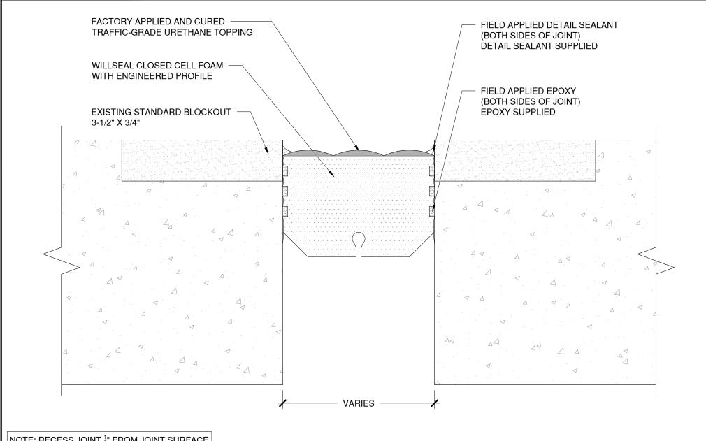
NOTE: RECESS JOINT 1/2" FROM JOINT SURFACE
