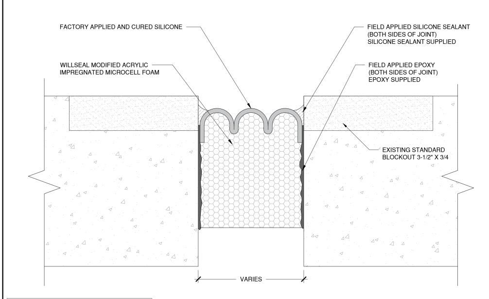
NOTE: RECESS JOINT  $\frac{1}{2}$ " FROM JOINT SURFACE.
